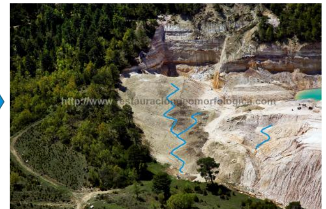
A la izquierda, vista aérea del comienzo de los trabajos de reconstrucción geomorfológica. A la derecha, zona ya remodelada (sector central de la imagen, con tonos ocre), en la que se representa en azul la red hidrográfica reconstruida. El canal corto situado a la derecha (sobre tonos blancos y rosáceos) muestra la zona en la que se está continuando la restauración, excavando un valle.
